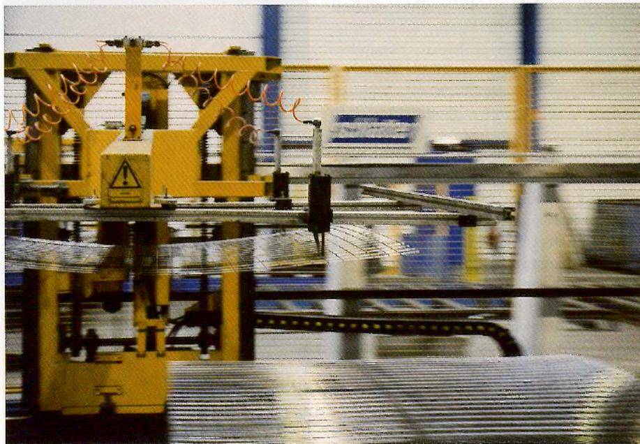
Handlingsautomaten sorgen für das kontinuierliche Ab stapeln und Palettieren der fertigen Gitter. So lässt sich die ganze Anlage von lediglich einem Maschinenführer bedienen.
