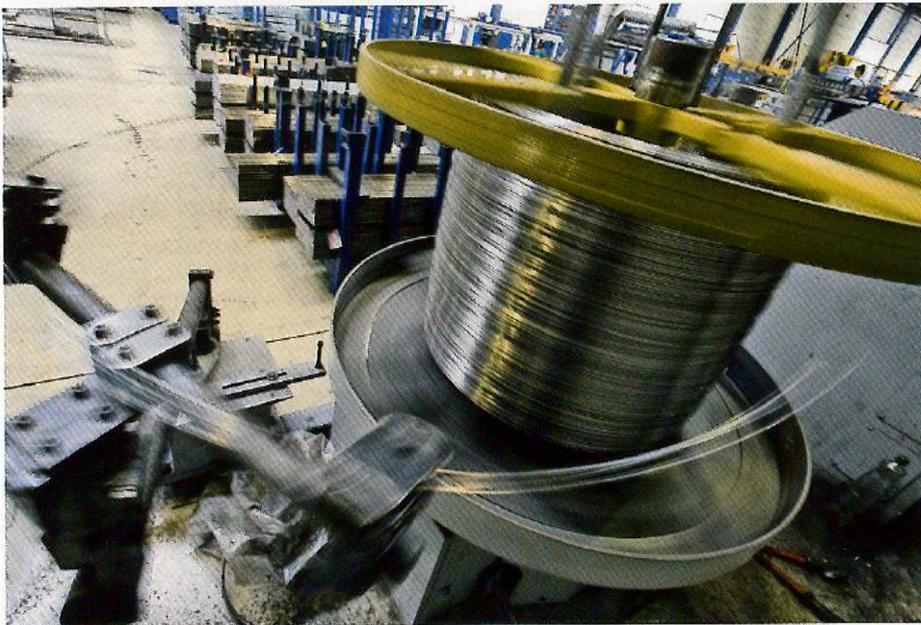
Blanker, verzinkter und Edelstahl-Draht wird von 2-t-Coils abgewickelt und zu den Richt- und Schneidmaschinen geführt. Trotz 2 m/s Durchlauftempo liegt die Längentoleranz unter 1 mm.
